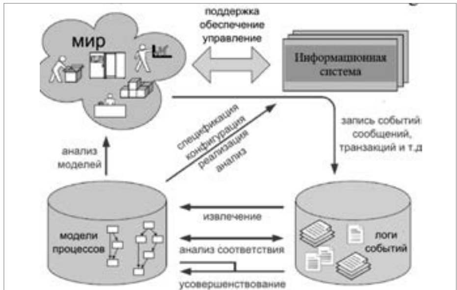
Рис. 2. Основные действия технологии Process Mining (Мир – это реальность, которая нас окружает, в том числе: люди, бизнес-процессы, оборудование, организации и др.).
